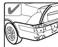
очищайте датчики ото льда с помощью горячей воды, продуйте датчики сжатым воздухом, для удаления влаги
