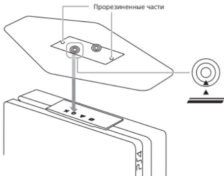
**4 Закрутите крепежный винт с помощью монеты или другого плоского предмета.**
