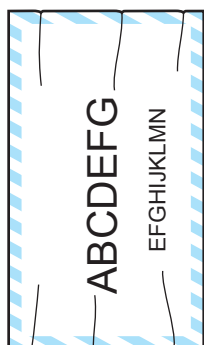
Конверты выходят со складками
