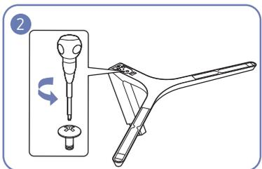
Открутите соединительный винт в нижней части подставки.
