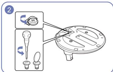
Открутите соединительный винт в нижней части подставки.
